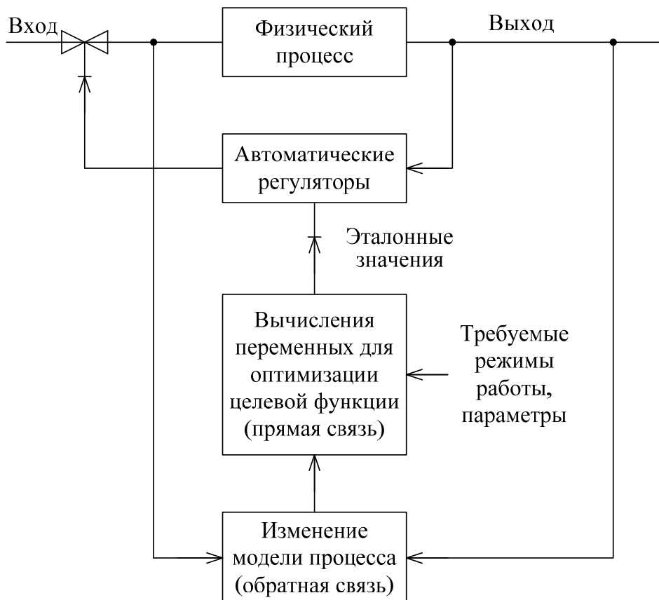
Рис. 1. Структурная схема с сочетанием прямой и обратной связи
